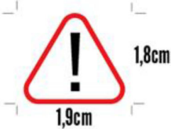
Triángulo con línea de trazo de 0,03 cm y las tres puntas con un vertice de 0,25 cm, Color rojo: R255 G0 B0 - CO M100 Y100 KO Al interior con el siguiente signo: “!”
